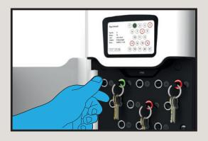
Toutes les clés et sets de clés sont verrouillées individuellement par le système Traka 21. Des LED vertes indiquent les clés auxquelles l'utilisateur a accès. L'utilisateur ne peut pas retirer les clés signalées par les LED rouges qui continuent à être verrouillées à leur place.
